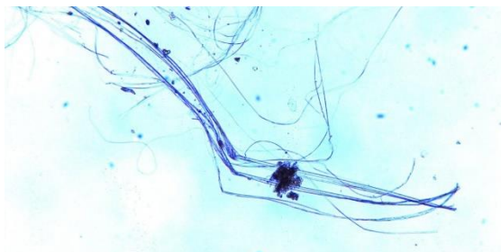
Asbestfiber set i mikroskop
