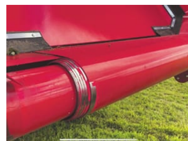
Dette har du heller ikke set før: Det er et langt, tyndt 1 mm stykke Hardoxstål, der trækker pladen. Det er patenteret og opfundet af Metsjö. Jernet trækker frontpladen til bagenden i bunden, og øverst kører frontpladen i en skinne på hver side. Foto: Esben Henneberg.
