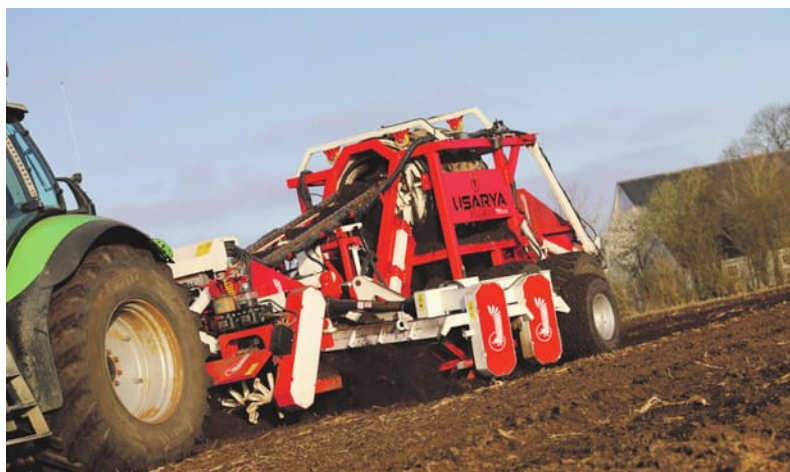
På den allerede forbedrede parcelmark med græs kom Grønning Smedie med deres importerede Usarya-stensamler og samlede sten og knolde sammen. Foto: Esben Henneberg.
