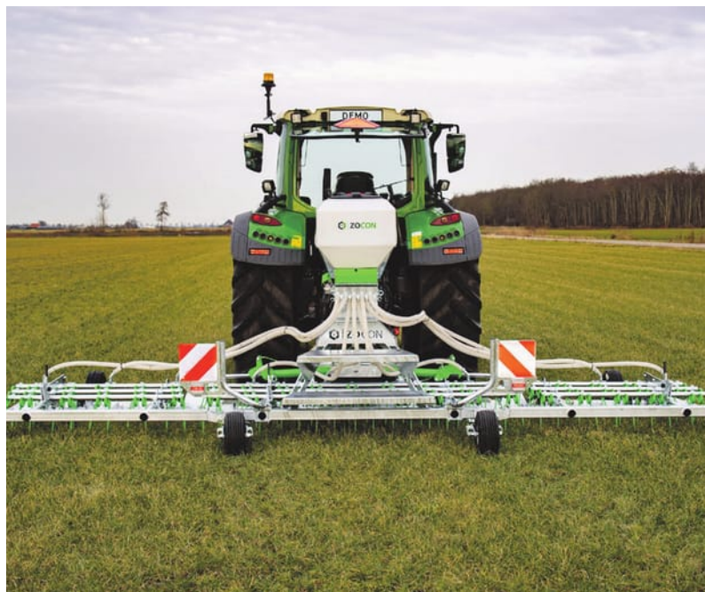
Zocon Greenkeeper med Zocon Seeder Pro frøsåmaskine monteret. Foto: Jens Lübeck Agro.
